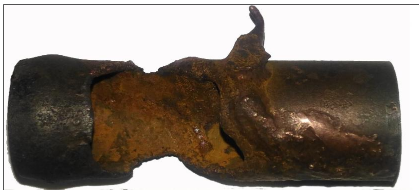
Рис. 2. Локальное проплавление стального патрубка сапуна двигателя свеклоборочного комбайна
